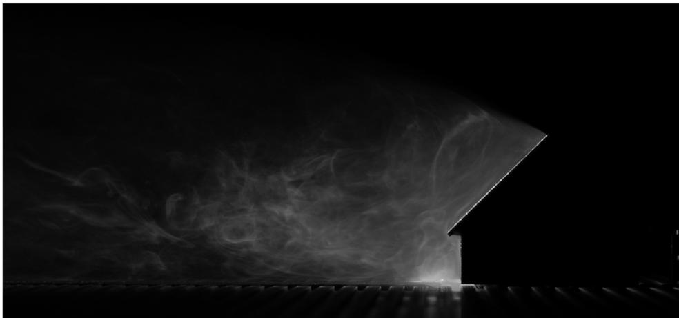
**Abbildung: Visualisierung der Strömung hinter einem Gebäude mittels Laserlichtschnitt (oben: Dachneigung 15°, unten: Dachneigung 45°)**
