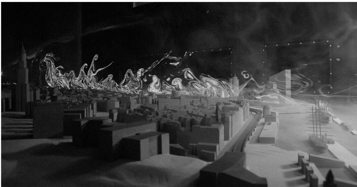
Abbildung 1: Visualisierung von Wirbelstrukturen im Hamburg-Windkanalmodell.
